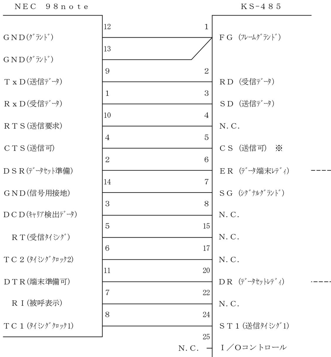
※ KS-485側のCS (送信可)はRS-485ラインからの入力信号が存在する時にホスト側の送信を制御するための信号線です。
