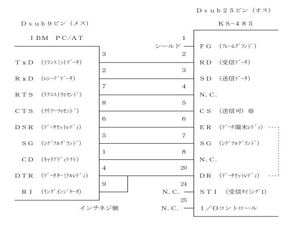
※ KS-485側のCS(送信可)はRS-485ラインからの入力信号が存在する時にホスト側の 送信を制御するための信号です。
