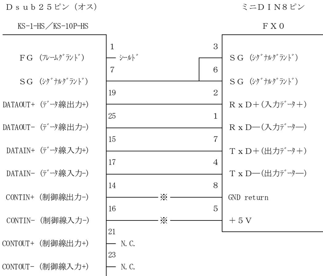
※ 通常はN.C.で作成して、RS-232C側でCTS・DSRに信号を与える。RS-232C側で処理できない場合に限り接続する。このとき、SW2はON側に設定する。
