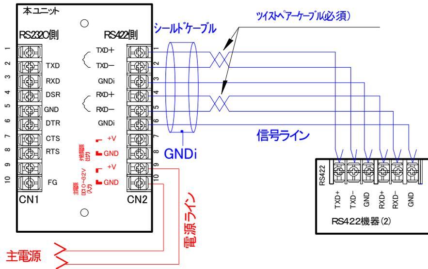
RS232C機器(PC等)に本ユニットを使用してRS422機器と1:1接続する配線図
