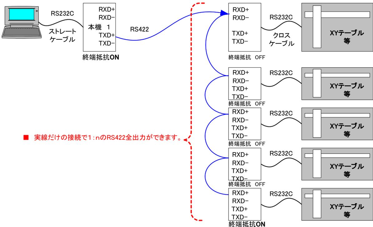
■ 実線だけの接続で1:nのRS422全出力ができます。
