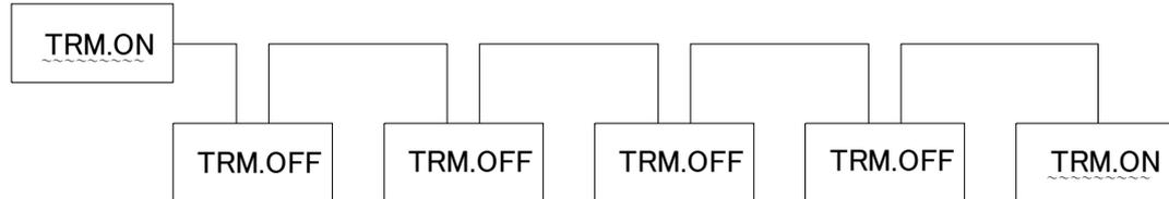
通常、複数接続を行った場合は、両端以外のターミネータは OFF にします。よって、最初と最後の機器の2台をターミネータON、残りすべての機器はターミネータOFFにします。本機もしくは当社製品はディップスイッチでこれらのON/OFFが行えますので状況に応じて切り替えてください。
