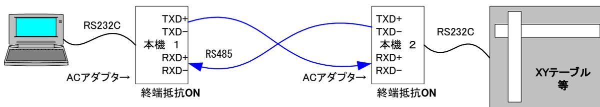
本機同士は片側を RJ45 電源出力設定に、片側を RJ45 電源入力設定にした場合は出力側だけに AC アダプタの組み合わせで運転することが可能です。
