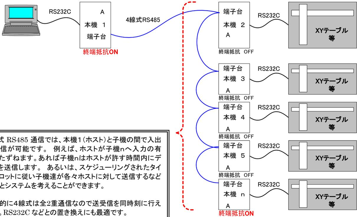
4線式 RS485 通信では、本機1(ホスト)と子機の間で入出力通信が可能です。例えば、ホストが子機nへ入力の有無をたずねます。あれば子機nはホストが許す時間内にデータを送信します。あるいは、スケジューリングされたタイムスロットに従い子機達が各々ホストに対して送信するなど色々システムを考えることができます。
