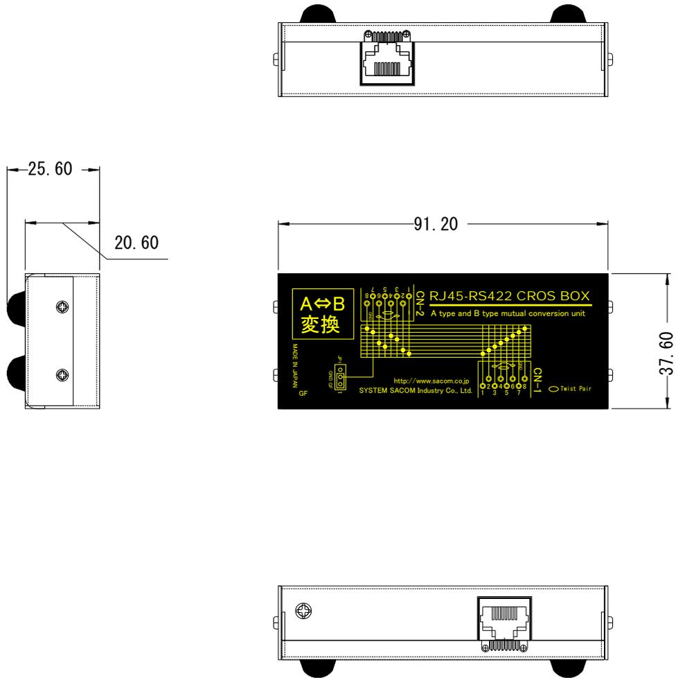
取付金具を使用して取付ける場合の外形図
