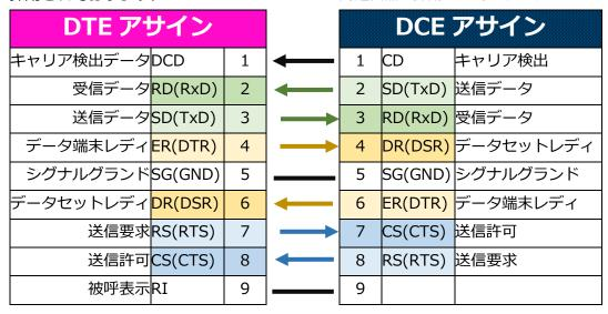
● DTE と DCE を接続するときはストレートケーブルを使用します。
