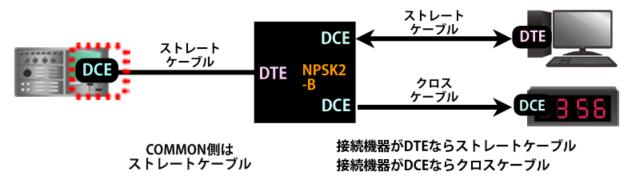
**COMMON 側**に **DCE 結線の機器**をストレートで接続すると、CH-1 と CH-2 は元の結線のケーブルで接続することが出来ます。
