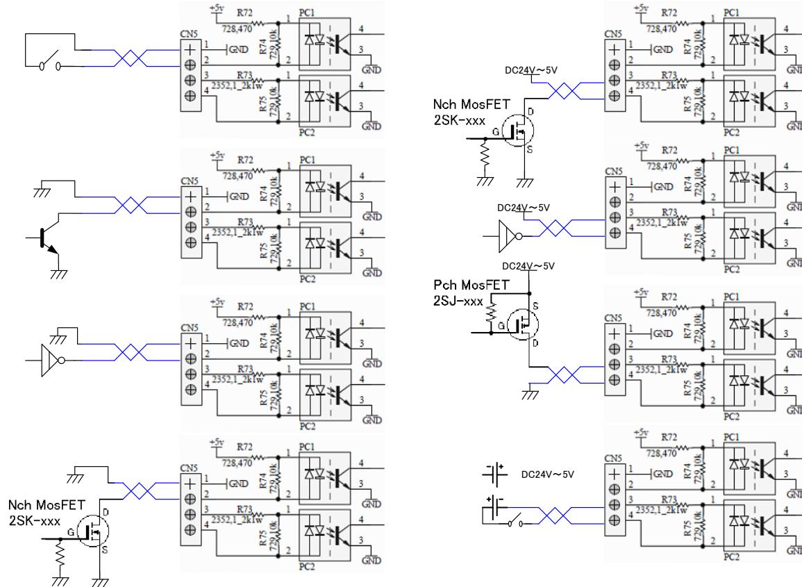
外部スイッチ等への電線は、ツイストあるいはツイスト&シールドケーブルを推奨します。シールドへは GND を接続します。（GND と接続の無いアースやフレーム GND (FG) を接続するとノイズを誘因する可能性があります）
