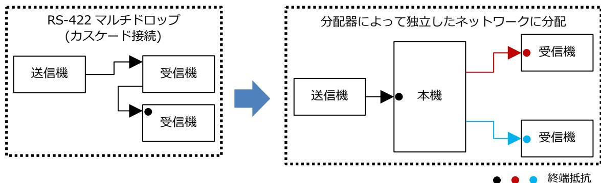
ネットワークが本機を介する事でケーブルの延長が行えます（リピータ機能）。
