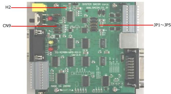
出荷時にはショートプラグ保管位置である JP3, JP4 にショートプラグがセットされています。その際は外部へ電源が供給されません。設定を変更し外部へ電源供給を行う場合は、上蓋側面の 4 本のネジを外し、ショートプラグを JP3, JP4 から下表の位置に差し換えてください。
