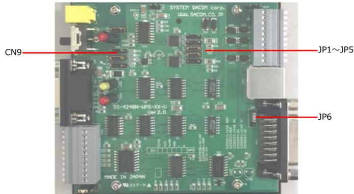
出荷時にはショートプラグ保管位置である JP3, JP4 にショートプラグがセットされています。その際は外部へ電源が供給されません。設定を変更し外部へ電源供給を行う場合は、上板側面の 4 本のネジを外し、ショートプラグを JP3, JP4 から下表の位置に差し換えてください。
