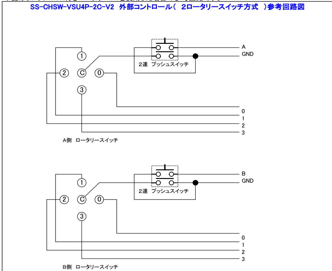
使用方法としては、まず、ロータリースイッチにて接続したいCHを選択します。
