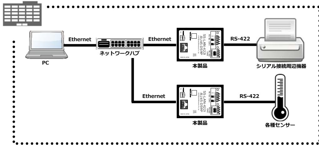
4.1.2 仮想COMポートを使用し、RS-422接続の周辺機器をVPN経由で遠隔接続する。
