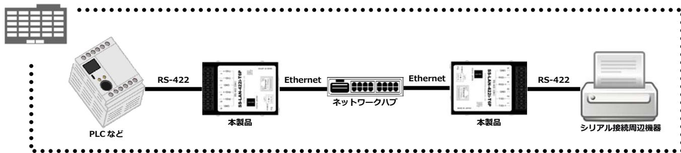
4.1.4 シリアルトンネリング機能を使用し、RS-422のみをもつ機器同士をVPNで遠隔接続する。
