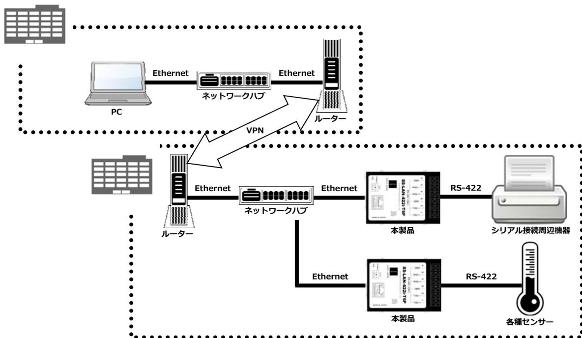
4.1.3 シリアルトンネリング機能を使用し、RS-422のみをもつ機器同士をLANで接続する。
