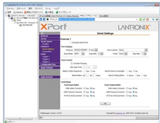
4.2.2 Configurable Pins > Functionを3か所全て General Purpose I/Oに、同じ画面の Directionを3か所全てInputに、Active Levelを3か所全てLowに設定します。設定を変更した場合はOKをクリックし、変更を確定します。
