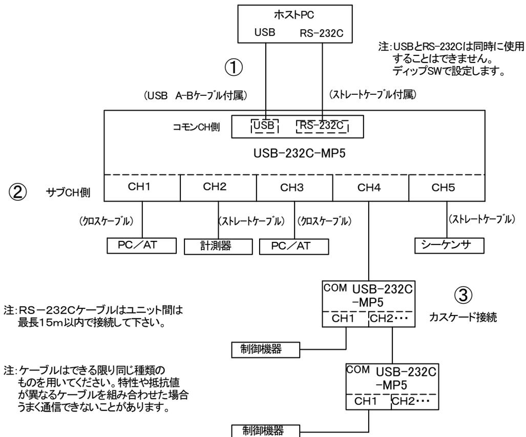
注意: ケーブルの(ストレート)(クロス)は必ずしもそうでない場合があります。ここでは、一般的な接続例を挙げてあります。機器のピンアサインを確かめて接続して下さい。
