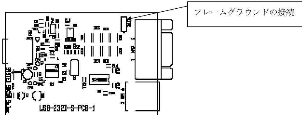
この作業はケースの天板を外して行います。ケース側面の 4 箇所のねじをドライバーで取ると天板を外すことができます。天板を外す時には USB ケーブルおよびその他コネクタにより接続されているケーブルを外してください。ケーブルなどが接続されたままで作業をしますと装置破損などの原因となります。
