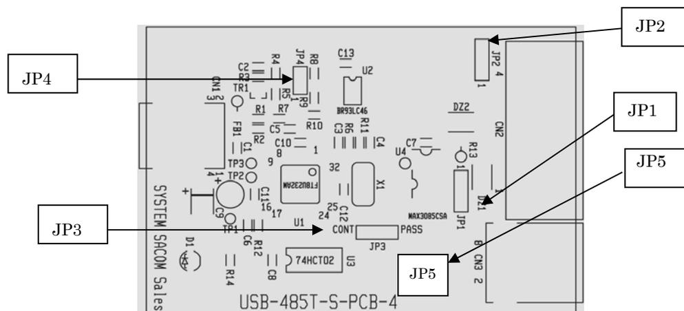
これらの設定を変更する作業はケースの天板を外して行います。ケース側面の4箇所のねじをドライバーで取ると天板を外すことができます。天板を外す時には USB ケーブルおよび端子台の接続およびその他コネクタにより接続されているケーブルを外してください。ケーブルなどが接続されたままで作業をしますと装置破損などの原因となります。
