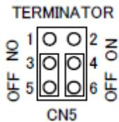
3 – 5 短絡、4 – 6 短絡で、終端抵抗未接続状態です（終端抵抗 OFF）
