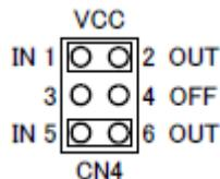
1-2短絡で、+5V電源を1ピンへ出力します。
