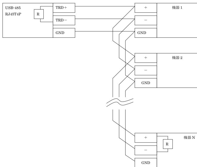
本変換器の 485 インターフェース側の接続例を表します。
