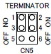
1 – 3 短絡、2 – 4 短絡で、終端抵抗接続状態です（終端抵抗 ON）：工場出荷状態
