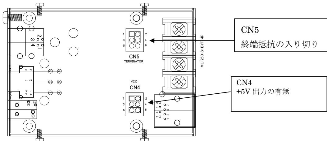
これらの設定を変更する作業はケースの天板を外して行います。ケース側面の 4箇所のねじをドライバーで取ると天板を外すことができます。天板を外す時には USB ケーブルおよび端子台の接続およびその他コネクタにより接続されているケーブルを外してください。ケーブルなどが接続されたままで作業をしますと装置破損などの原因となります。
