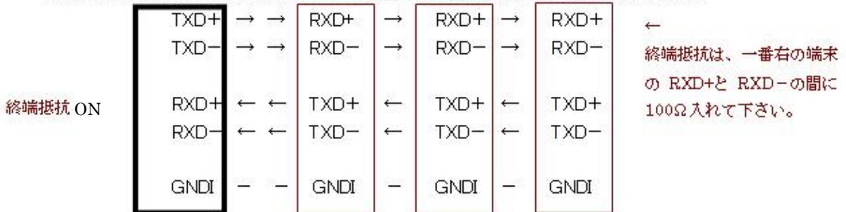
プログラム例は、まずホスト(黒枠)から他の全機へ送信データを送ります。そして、そのデータに答えるたった1端末のレスポンス返答をホストが受信します。(もし2台が返答するとデータは混信します) ですので端末には ID 等の識別機能が必要です。また、終端抵抗は物理的な最遠方の両端だけに、それぞれ抵抗(1W100Ω~120Ω)接続あるいは終端スイッチ ON 等の設定を行って下さい。本機は内部に JP がありますのでそれを設定して下さい(工場出荷は終端接続有りになっています)
