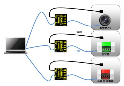
接続例(2) 各 USB 装置間の GND が共通で良い場合の絶縁例
