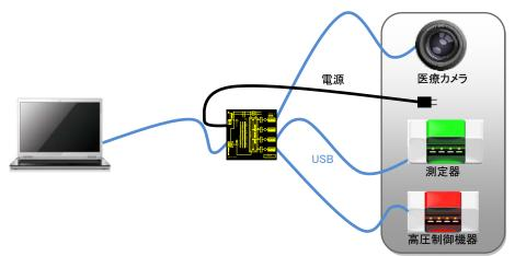
絶縁とは、通信信号的には接続されているけれども、電気的に接続されていない状態を言います。 一般の USB・HUB での USB 機器接続は、全ての機器の GND ラインが全て接続されてしまいます。 しかもそれは USB ケーブルと言う GND 接続用ではないものによって暗黙のうちに行われてしまいま す。 そこで本製品接続により下記のような利点が考えられます。
