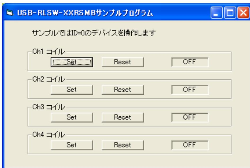
サンプルでは本機の ID が 0 (全て OFF)になっている場合のみ、上図のウィンドーが表示されます。ここで各々 Set や Reset ボタンを操作することにより、リレー音がして接点が開閉(テスト等でチェック)することを確認できます。
