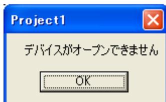
もう一度、デバイスマネージャーを確認しながら、本機の USB を抜き差しして、? や ! マークが抜き差しに反応して表示されているものがあれば、(本機のドライバ)それを削除し、PC を再起動し、再度はじめからインストールを手順どおり、やり直してみてください。また、もしデバイスマネージャー上で正常動作であったとしてもそれを削除して、PC を再起動し、再度始めから手順どおり、インストールをお試し下さい。
