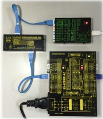
上記写真の例では A タイプの USB-422I RJ45-T10P と A タイプの SS-422IRP-AC を市販 LAN ケーブルのみで接続し、動作させています。
