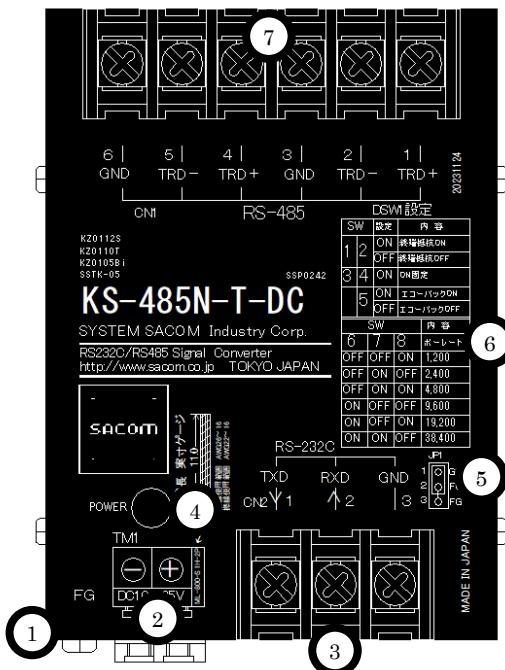
1. (FG) フレームグランド端子 必要に応じて接地してご使用ください。
