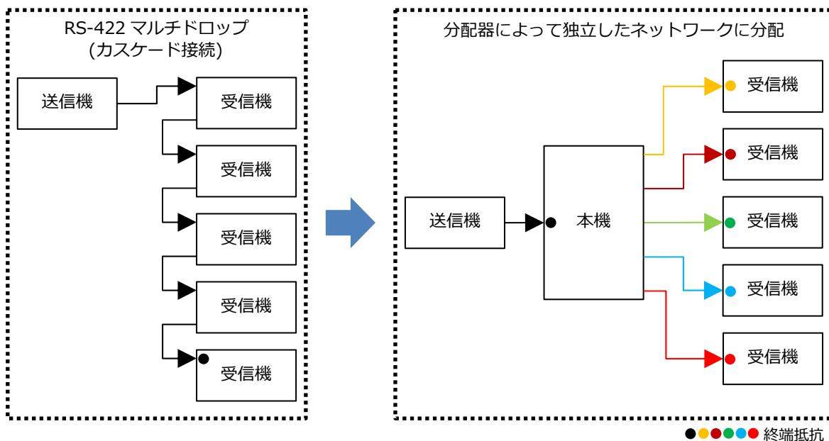
ネットワークが本機を介する事でケーブルの延長が行えます（リピータ機能）。
