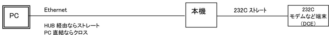
もし PC や PLC 等のいわゆる DTE を接続する場合は 232C クロスケーブルを使用して下さい。
