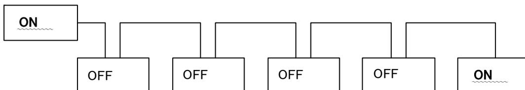
反射波防止として伝送路安定化の目的でフェイルセーフ終端方式を採用しています。
