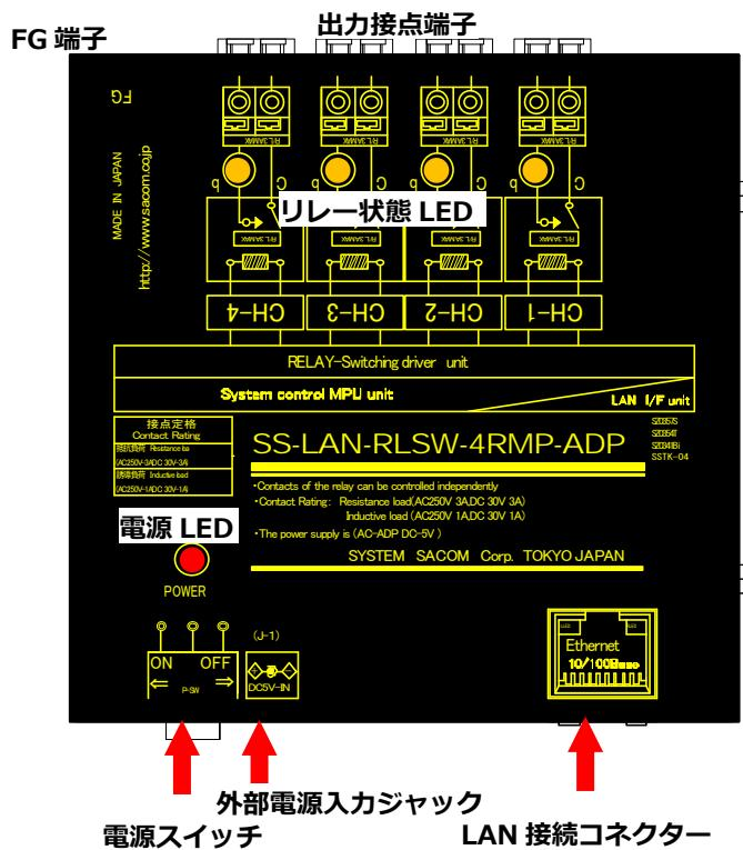
**LAN接続コネクター** LAN(Ethernet)に接続するRJ45 コネクターです。カテゴリー5 以上のLANケーブルでネットワークハブなどに接続します。
