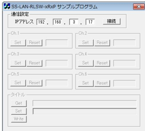
4.2.3 本機に設定してあるIPアドレスを入力し、「接続」ボタンをクリックします。接続に成功すると下記の画面が表示されます。
