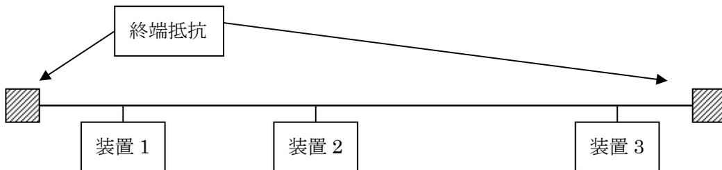
各装置と幹線間の線(支線)は極力短くします。
