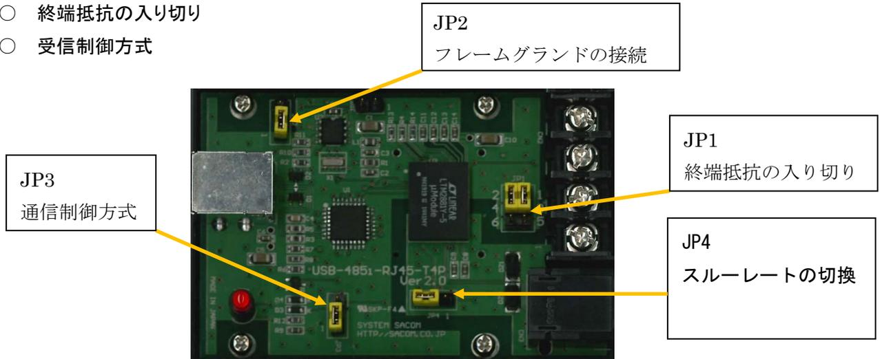
これらの設定を変更する作業はケースの天板を外して行います。ケース側面の4箇所のねじをドライバーで取ると天板を外すことができます。天板を外す時には USB ケーブルおよび端子台の接続およびその他コネクタにより接続されているケーブルを外してください。ケーブルなどが接続されたままで作業をしますと装置破損などの原因となります。
