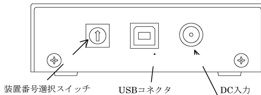
USBコネクタ : コンピュータと付属のUSBケーブルで接続します
